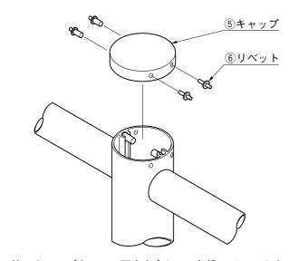
●柱にキャップをかぶせ下穴を合わせて打込みリベットを 差し込んだ後、リベットのヘソをたたき込んで下さい。
